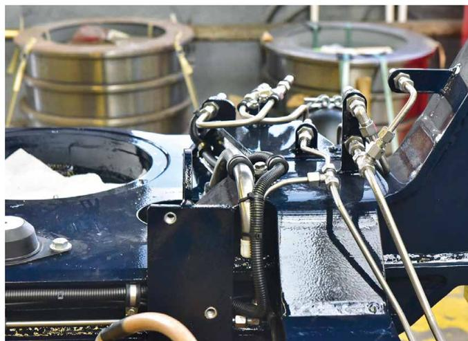
Am aufgearbeiteten Drehgestellrahmen werden die Druckleitungen für viele weitere Betriebsjahre erneuert.
