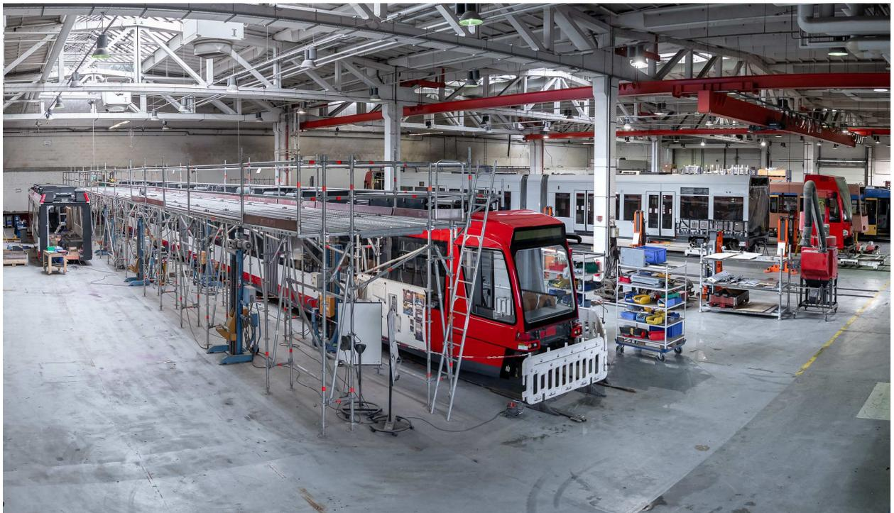
*Die Verlängerung der Arbeitsstände war der Hauptgrund für den Abriss der Empore. Maximal 42 Meter lange Bahnen passen nun in die Halle. Die GT8N der VAG Nürnberg (hier im Bild) waren 38 Meter lang.*
