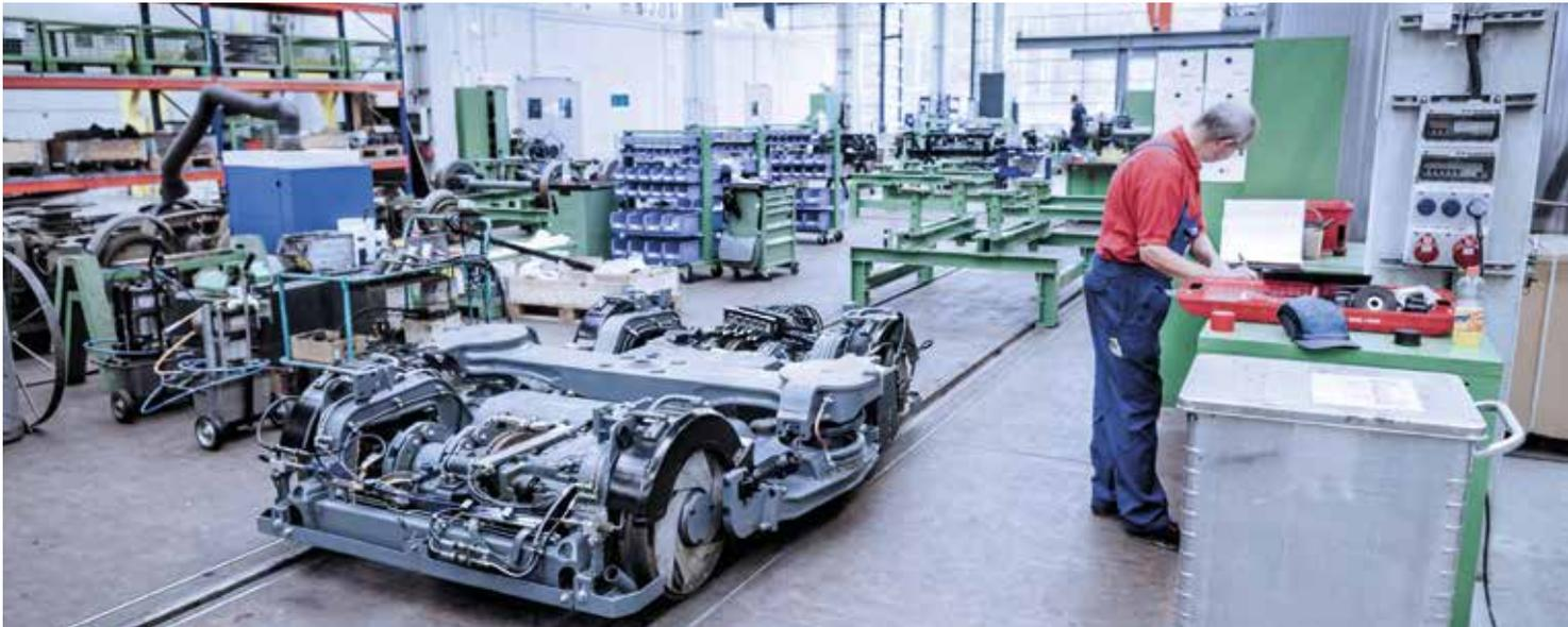
Die Sicherheit des Wagenlaufes und eine möglichst geringe Beanspruchung von Rad und Schiene im Fahrbetrieb stehen bei der Aufarbeitung von Fahrwerkskomponenten im Fokus. Gerade durch die hohen Anforderungen an die Fahrwerke von Schienenfahrzeugen und die damit verbundene Verantwortung gegenüber den Fahrgästen im ÖPNV sind Sorgfalt und Genauigkeit sowie ein hoher technischer Standard der Arbeiten unverzichtbar.
